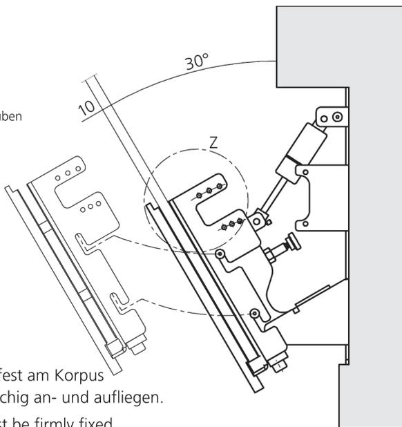
Der Kippbeschlag muss fest am Korpus montiert sein und vollflächig an- und aufliegen.
