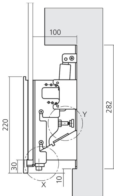
Durch das Lösen der Schrauben kann der Glashalter separat entnommen werden.
